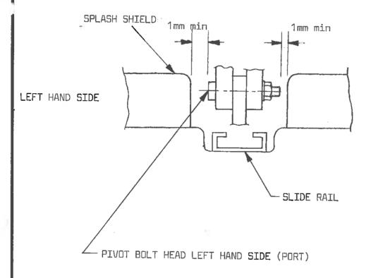
FIG 1 - CANOPY SLIDE RAIL VIEW LOOKING FORWARD
